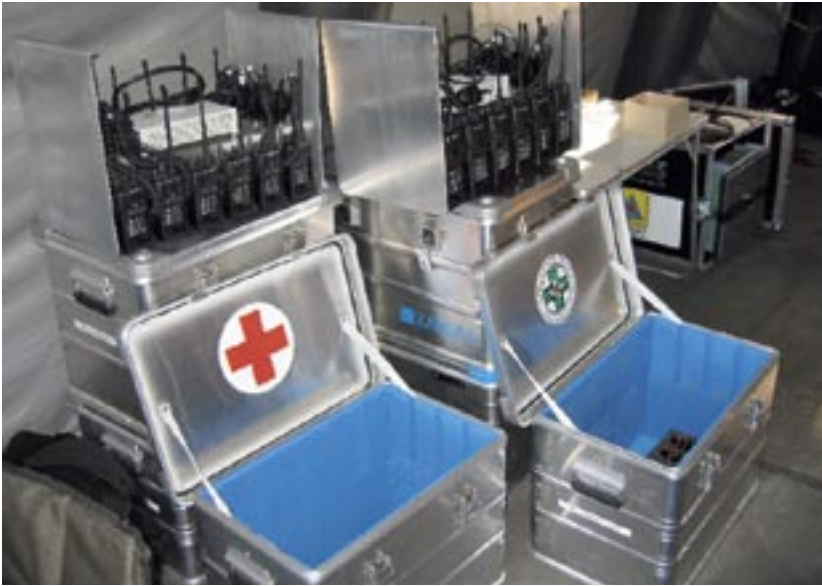
Abb. 5: Sieben Endgeräteboxen mit insgesamt 84 Handfunkgeräten und 84 Pägern (Text-Rufempfänger) stehen zur Unterstützung anderer Einsatzkräfte zur Verfügung
