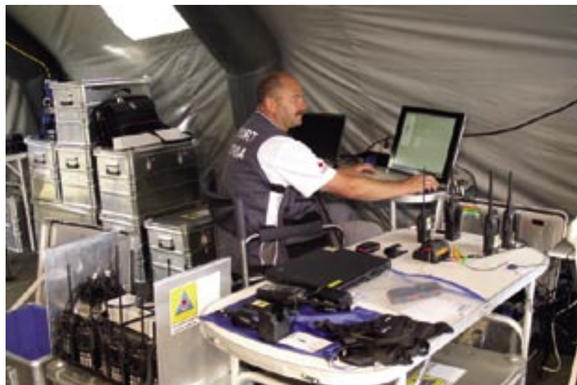
Abb. 8: Die 84 Handfunkgeräte und 84 Rufempfänger werden vor der Ausgabe entsprechend konfiguriert und programmiert
